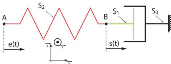
On déplace l'extrémité A d'une longueur  $e(t)$ . Le point B répond à ce déplacement en se déplaçant d'une longueur  $s(t)$ . En isolant le solide  $S_1$  de masse ( $m$ ), on obtient le bilan des actions mécaniques extérieures suivant  $\vec{x}$  :
