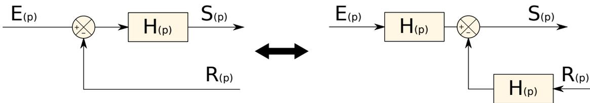
FIGURE 19 – Déplacement en amont d'un point de prélèvement
