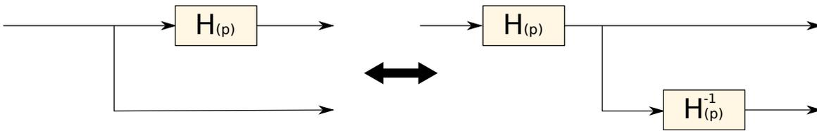
FIGURE 17 – Déplacement en mont d'un point de prélèvement
