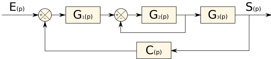
**e) Déplacement des blocs autour des points de prélèvement**
