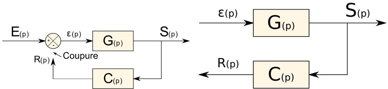
FIGURE 15 – Schéma-bloc d'un système en boucle ouverte
