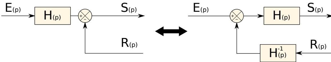
FIGURE 18 – Déplacement en aval d'un point de prélèvement
