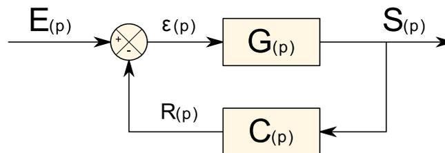
FIGURE 14 – Schéma bloc d'un système en boucle fermée
