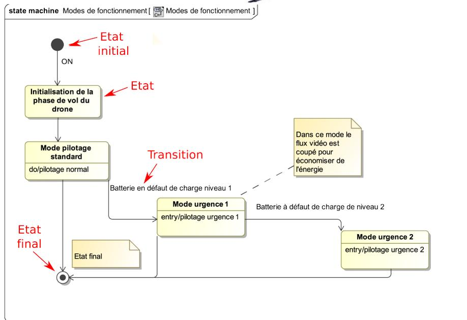
Ce diagramme permet de modéliser le passage d'un mode de fonctionnement à un autre du drone. Il est composé :
