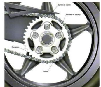
L'entraînement se fait par obstacle. Le dimensionnement de la transmission est essentiellement basé sur la capacité de la chaîne à supporter l'effort de traction. De même que pour les courroies, on peut utiliser un dispositif assurant la tension constante de la chaîne.
