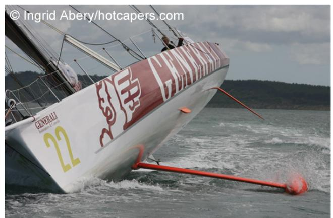
La quille est manœuvrée par deux vérins hydrauliques. Chacun d'eux est piloté par une servovalve de débit. Ce composant délivre un débit  $q(t)$  proportionnel à sa tension de commande  $v(t)$ .
