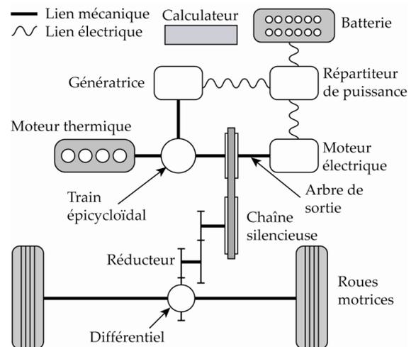
A partir de la position de la **pédale d'accélérateur** et de la vitesse du véhicule, le **calculateur** détermine la **vitesse de rotation optimale** du **moteur thermique** et la consigne d'ouverture du papillon des gaz. La puissance en sortie du moteur thermique est transmise, grâce à un **train épicycloïdal**, à la **chaîne silencieuse** et à la **génératrice**.
