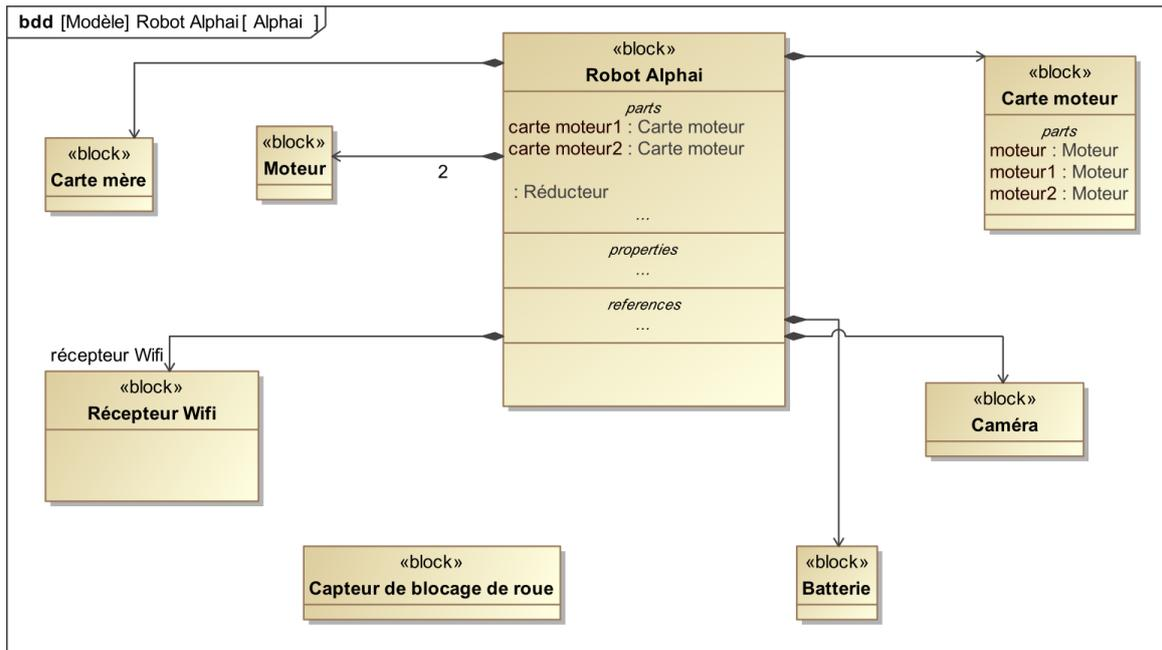
Q 9 : En se basant sur le diagramme de définition de bloc, proposer une architecture fonctionnelle sous une forme de chaîne fonctionnelle.
