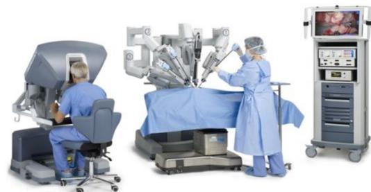
Outre le confort opératoire pour le chirurgien, le principal avantage du système robotisé est de permettre le traitement des commandes générées par la console, avant que ceux-ci ne soient transmis aux robots esclaves. On peut par exemple utiliser ce traitement pour :
